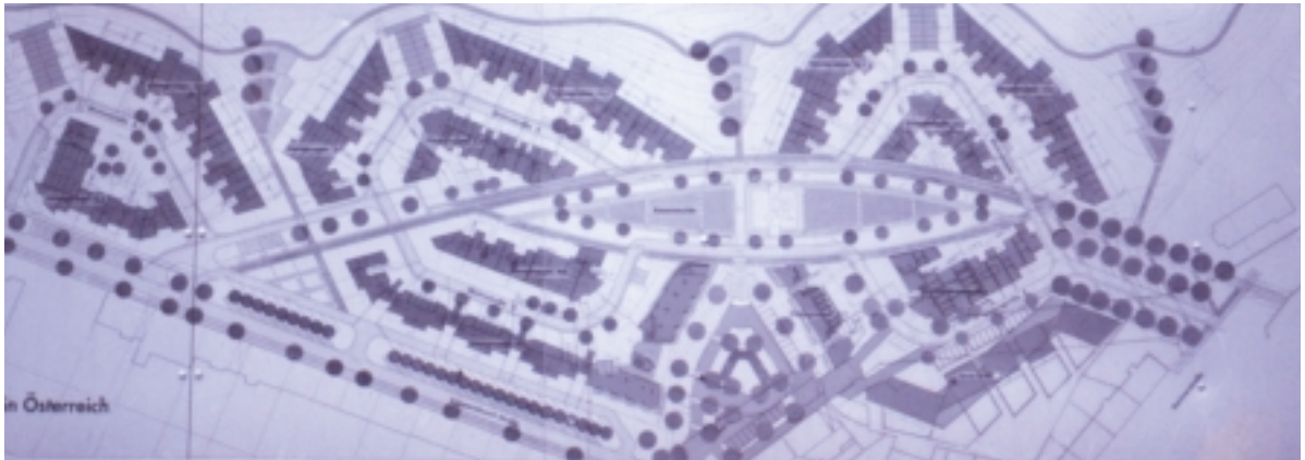
Foto 3 Gelsenkirchen (D. woonwijk Küpperbusch). Het stedenbouwkundig plan voorziet centraal in deze wijk een lensvormige infiltratieplas. Daar wordt regenwater in opgevangen en infiltreert het in de bodem.
